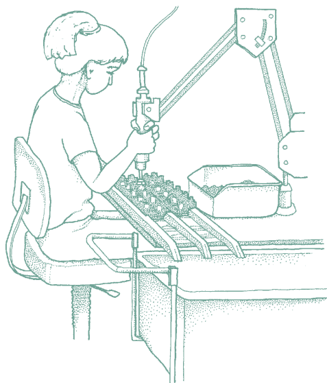
Fig. 4.8 Vue du poste réaménagé. Notez le rapprochement des rails et l'installation d'un pantographe qui diminuent les contraintes au niveau de l'épaule et les exigences de force lors du vissage.
