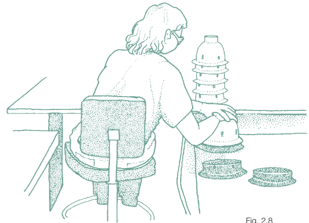
Fig. 2.8 Pour assembler le réflecteur au déflecteur, la travailleuse doit effectuer un effort significatif.
